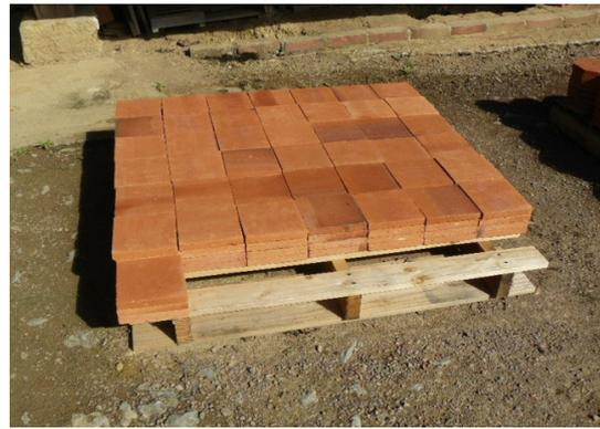
Aber wie sollte es auch anders sein. Einen Ziegel nach der alten Tradition zu fertigen, dauert mehrere Wochen. Der Ton wird grob zugeschnitten, genauer zugeschnitten, gepreßt, trocken gelassen, langsam erwärmt, erhitzt, und schließlich gebrannt, nur um dann ganz langsam wieder abzukühlen. Das ist kein Handwerk. Das ist Kunst !
